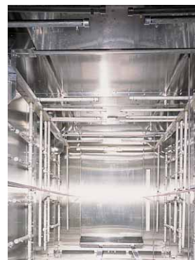
同一エリアで、洗浄・すすぎ・乾燥を、コンテナを傾斜させて効率良く行います。
