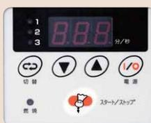
1メニューにつき最大9ステップまでのプログラムが登録可能で、強火炊き、弱火炊き、蒸らしの各工程を自由に組み合わせてそれぞれに調理時間を設定できます。たとえば炊き上がり直前に強火炊きを行いおこげを作るなど、ボタンひとつで簡単にこだわりの釜めしが可能です。初期設定では①強火炊き3分、②弱火炊き9分30秒、③強火30秒となっています。
